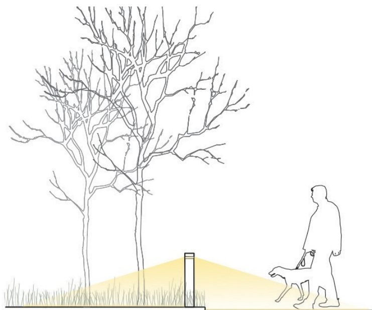
Principsnit 2: Sti i landskab/promenade - Belysningen holdes lavt og er med til at skabe et trygt og sikkert miljø.
