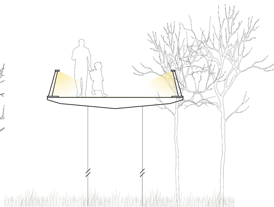
Principsnit 4: Sti-bro - belysning integreret i håndliste. Dette for at sikre at der ikke spredes unødigt spildlys på omgivelserne under broen.
